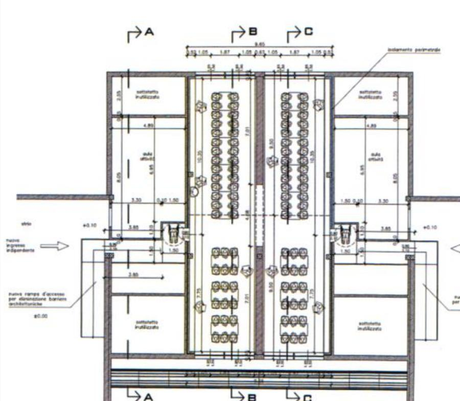
PIANTA DI PROGETTO CON INDICAZIONE DEGLI ACCESSI E DELLA DISPOSIZIONE DEGLI ARREDI
